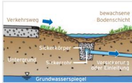
Abbildung 7 | Mulden-Rigol
